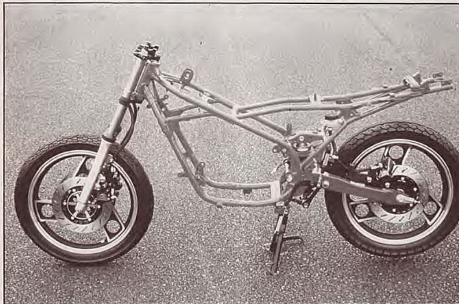
Chasis doble cuna, al más puro estilo competición, y suspensión posterior monoshock de geometría variable.
