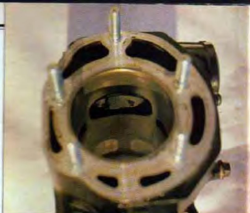
Vista de la pareja de cilindros en su lado de admisión. Tanto la camisa como el cilindro deben estar bien enfrentados, eliminando rebabas y descentramientos. A la derecha vista del escape de un cilindro. Hay que eliminar los residuos de combustión y comprobar el correcto ajuste del «power valve».
