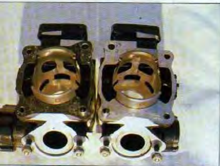
Vista de la pareja de cilindros en su lado de admisión. Tanto la camisa como el cilindro deben estar bien enfrentados, eliminando rebabas y descentramientos. A la derecha vista del escape de un cilindro. Hay que eliminar los residuos de combustión y comprobar el correcto ajuste del «power valve».
